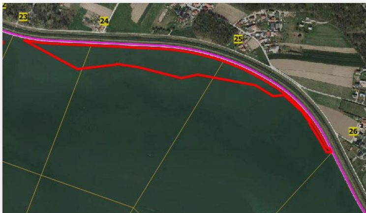
Slika 4: Območje 2 omejeno z rdečo plastnico na koti 218,00 mn.m. in obstoječi nasip iz že prečrpanih sedimentov.
